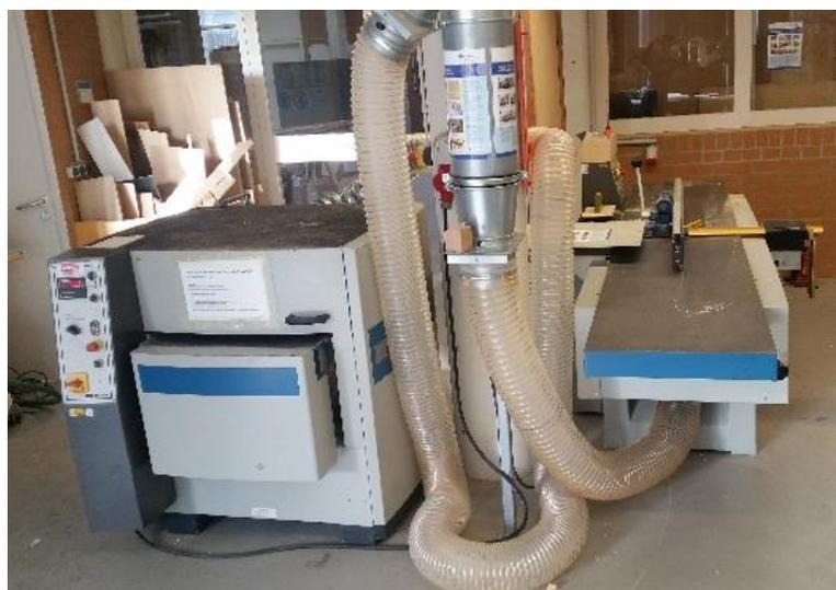
Die älteren Hobelmaschinen in der Bauhalle entsprachen nicht mehr den Sicherheitsanforderungen der Berufsgenossenschaft. An beiden Maschinen fehlte ein Notausschalter und an der Abrichthobelmaschine mangelte es an einer vorschriftsmäßigen Abdeckung der Messerwelle. Es kam die Idee auf, diese durch die in der Holzwerkstatt stehenden Hobelmaschinen zu ersetzen.
