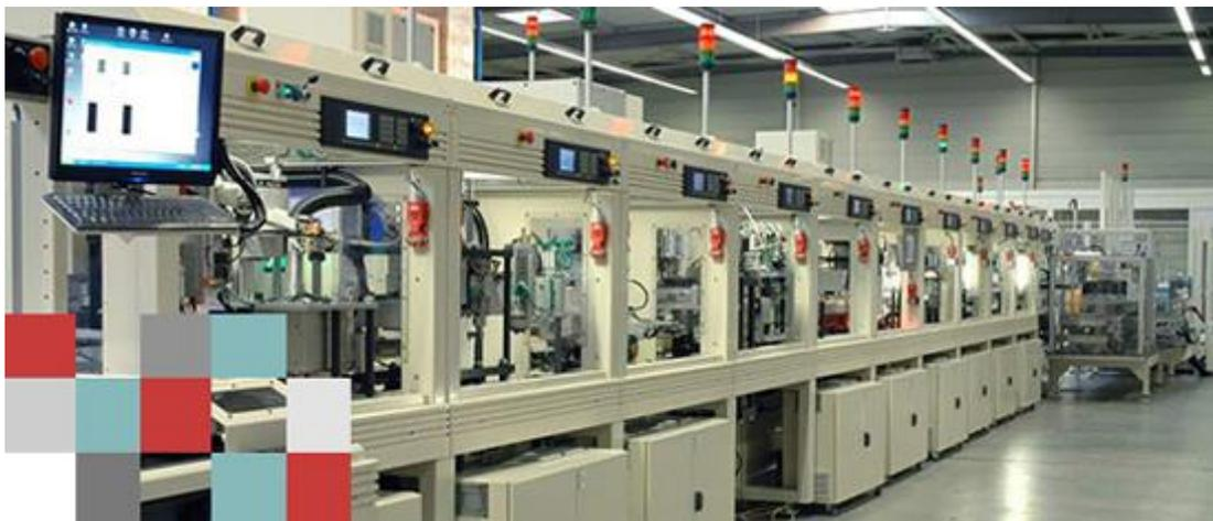
Produktionslinien von IPTE bestehen aus mehreren Modulen. Diese sind standardisiert und werden nach dem jeweiligen Prozessschritt angepasst. Hier wird versucht so viel wie nur möglich zu standardisieren, was bei derart komplexen Funktionen nicht einfach ist. Durch die Standardisierung wird auch die Wirtschaftlichkeit optimiert.
