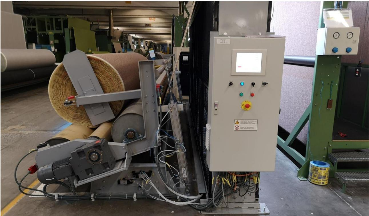
Gleich zu Beginn durften wir eine ihrer hauseigenen Konstruktion für die Teppichproduktion verdrahten, es mussten Motoren angeschlossen und Sensoren platziert werden, ebenso mussten alle Kabel dann im Schaltschrank verdrahtet werden. Das hat eine der 3 Wochen in Anspruch genommen. Weitergehend mussten wir Schaltschränke aufbauen, Kabelkanäle montieren, Bus-systeme in Serverschränken platzieren, einen kleinen Schaltkasten verdrahten und einen Fingerscanner einrichten.
