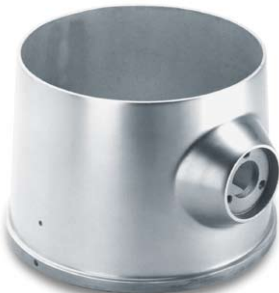
Aufnahmezylinder für Lebensmittelverarbeitung Peraluman-30 Kokillenguss, dekorativ anodisiert Ø 220 × 330 mm, Gewicht: 3,5 kg
