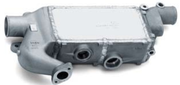
Querstromkühler Silafont-13 Kokillenguss, Schweißkonstruktion mit Knetlegierung 450 × 410 × 110 mm, Gewicht: 4,5 kg
