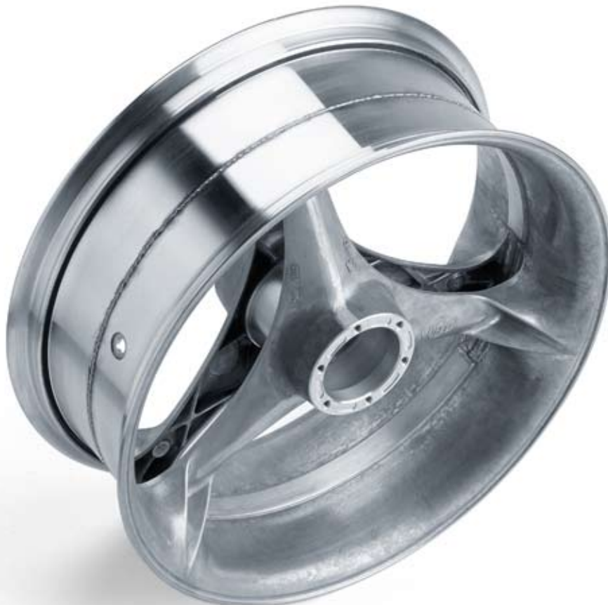
Felge, Motorrad MZ Magsimal-59, Gusszustand Druckguss, zweiteilig gegossen, Elektronenstrahl-geschweißt Ø 460 × 180 mm, Gewicht: 6,4 kg
