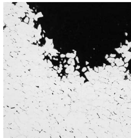
Abb. 3: Mikroschliff eines Sandgussstückes nach längerem Korrosionsangriff
