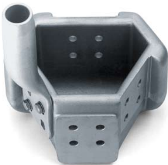
Flachanschlussklemme Anticorodal-71, überaltert Kokillenguss 180 × 240 × 240 mm, Gewicht: 5,6 kg
