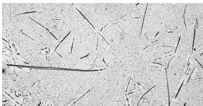
Abb. 13: Ansammlung von eisenhaltigen, intermetallischen, plattenartigen Phasen in überveredeltem AlSi12
