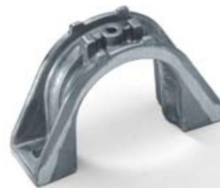
Stabilisatorstangen-Halter Magsimal-59, Gusszustand Druckguss, Wanddicke 3 mm 130 × 85 × 45 mm, Gewicht: 0,2 kg
