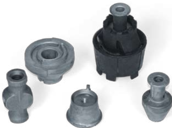
Lagerkerne für Schwingungsdämpfer Unifont-94 Druckguss, Gummi-Metall Verbund Ø 45–80mm Höhe: 40–123mm, Gewicht: 78–450 g
