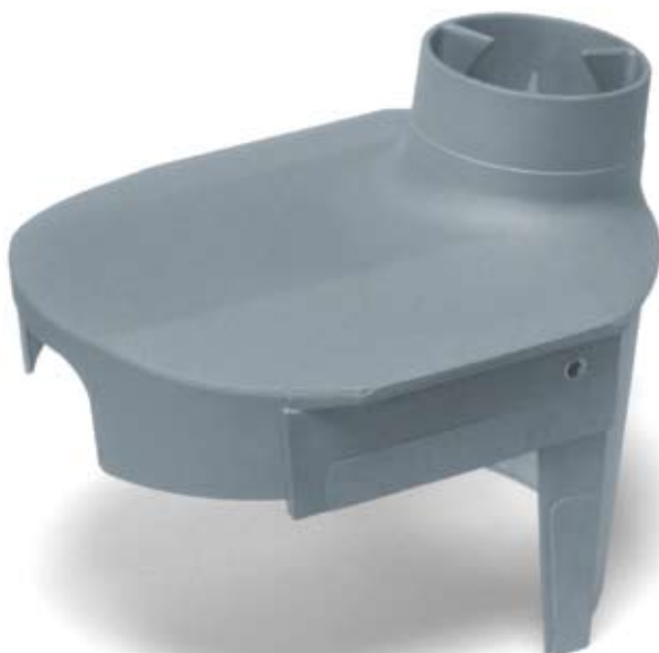
Deckel für Holzbearbeitungsmaschine Anticorodal-50, Gusszustand Kokillenguss, hartanodisiert 450 × 310 × 330mm, Gewicht: 5,0kg
