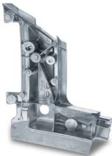
Verdeckversteifung Castasil-37 Druckguss, schweißgeeignet 260 × 220 × 60 mm, Gewicht: 0,6 kg
