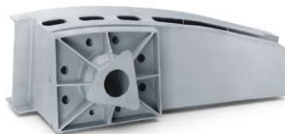
Landeklappenaufhängung Airbus 320 Anticorodal-72, warmausgehärtet Niederdruck-Feinguss 575 × 250 × 210 mm, Gewicht: 4,7 kg
