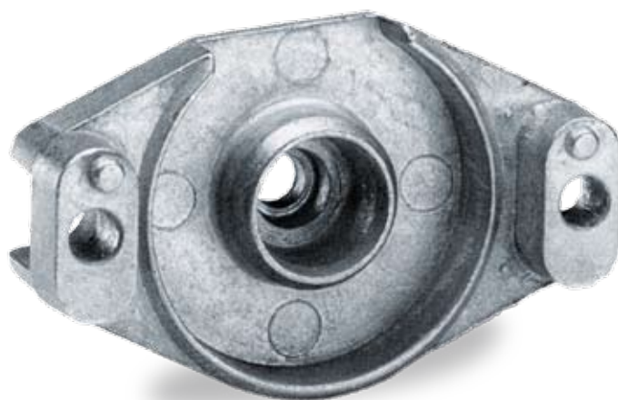
Elektromotorschild Anticorodal-04 Druckguss 55 × 32 × 18 mm, Gewicht: 20 g
