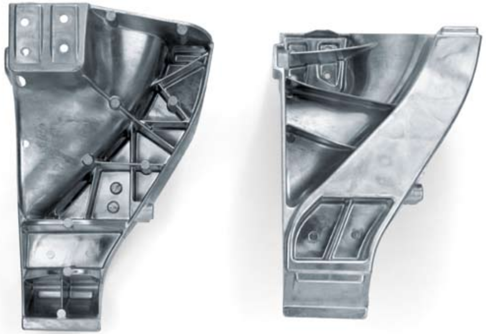
Längsträgerknoten einer Aluminiumkarosserie Castasil-37 Druckguss, schweißgeeignet 340 × 210 × 200mm, Gewicht: 2,0kg
