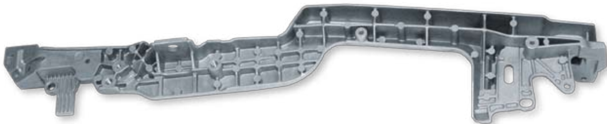
Cabrioverdeckhebel Magsimal-59, Gusszustand Druckguss, Wanddicke 2–5 mm 740 × 130 × 125 mm, Gewicht: 1,3 kg
