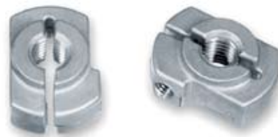
Sicherungsmutter Lenksäule Silafont-36 Druckguss 20 × 12 × 7 mm, Gewicht: 9 g
