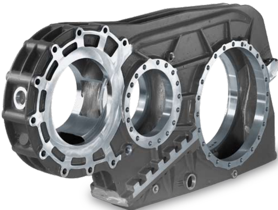
ICE II Getriebegehäuse Alufont-52, warmausgehärtet Sandguss 1800 × 850 × 250mm, Gewicht: 175 kg
