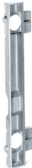
LKW-Kühlersammler Silafont-13 Kokillenguss 800 × 140 × 120 mm, Gewicht: 3,8 kg
