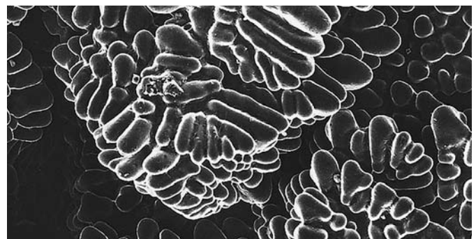
Abb. 4: Aluminium-Körner, bestehend aus Dendriten
