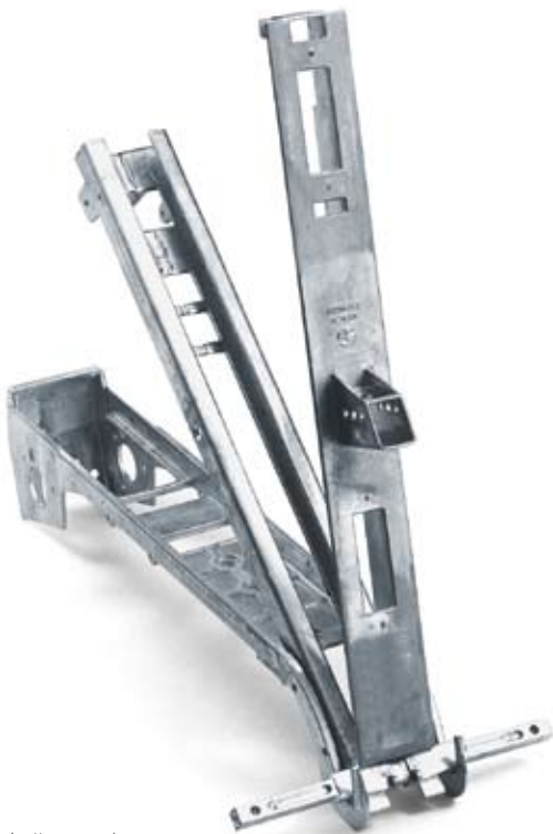
Leiterverankerung Silafont-13 Niederdruck-Kokillenguss, Schweißkonstruktion 820 × 250 × 370 mm, Gewicht: 5,6 kg
