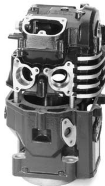
Zylindergehäuse mit Zylinderkopf Silafont-70, warmausgehärtet Kokillenguss 290 × 175 × 170 mm, Gewicht: 5,4 kg
