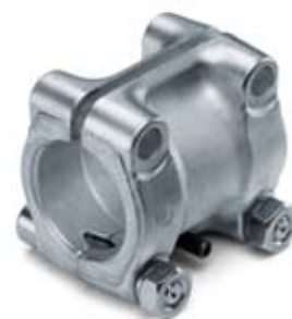
Klemmelement Alufont-52, warmausgehärtet Kokillenguss 70 × 70 × 30mm, Gewicht: 0,1 kg
