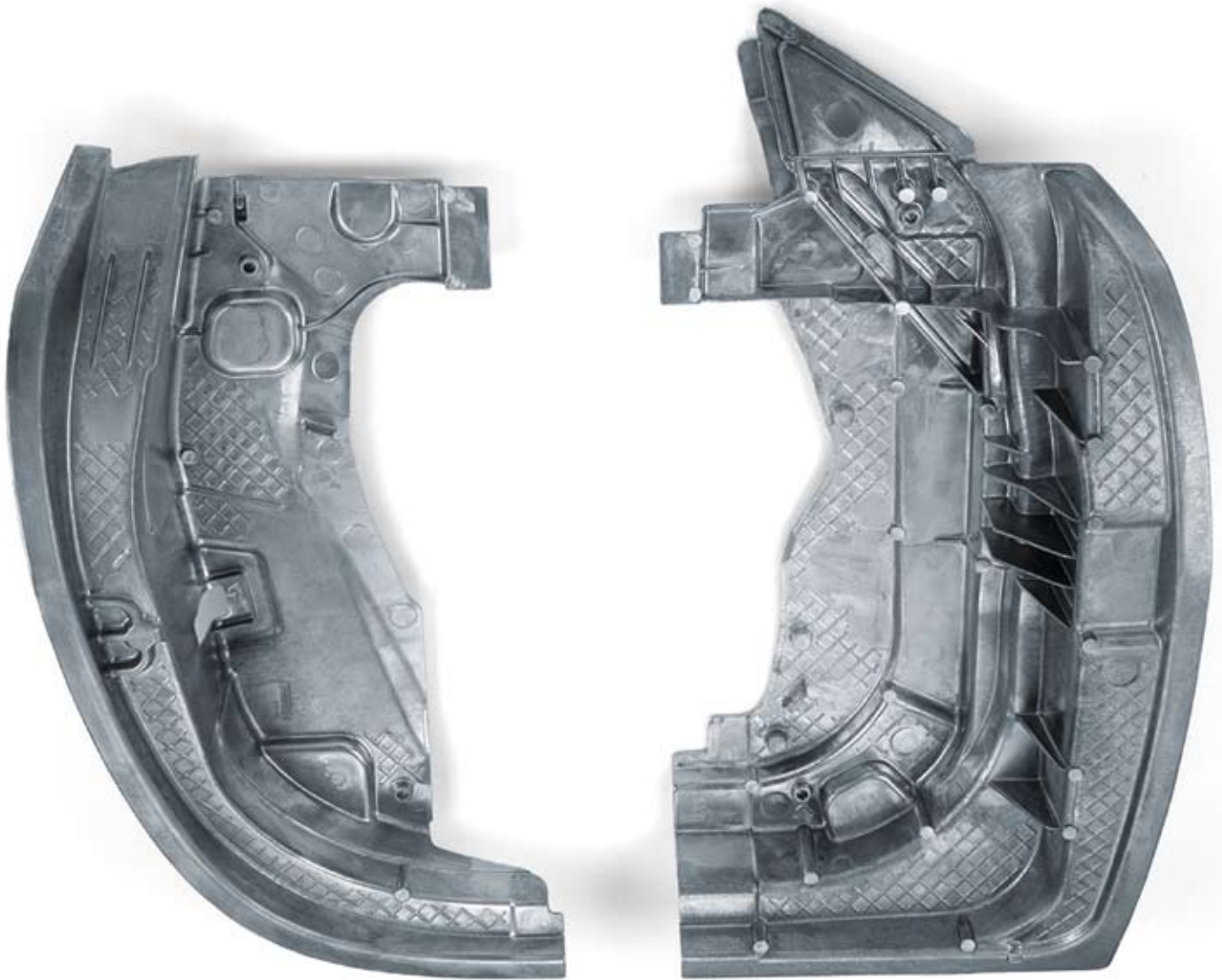
Türinnenteile eines Sportwagens Castasil-37 Druckguss 620 × 340 × 170 mm, Gewicht: 1,2 kg 700 × 340 × 170 mm, Gewicht: 2,1 kg
