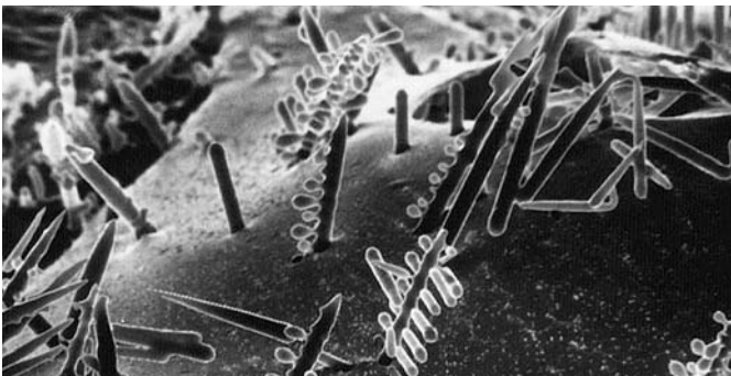
Abb. 1: Dendriten senkrecht zur Gussoberfläche wachsend
