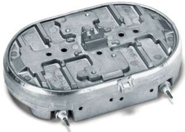
Heizplatte für Espressoemaschine Silafont-09 Druckguss, gebördelt 138 × 91 × 42 mm, Gewicht: 0,71 kg
