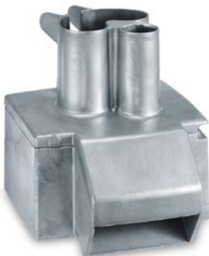
Gehäuse für Nahrungsmittelverarbeitung Silafont-36, zweiteilig Druckguss, kugelpoliert 360 × 300 × 335mm, Gewicht: 7,0kg
