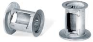
Gurtaufrollspindel Magsimal-59, Gusszustand Druckguss, Wanddicke 1,0–5,0 mm Ø 56 × 55 mm, Gewicht: 66 g
