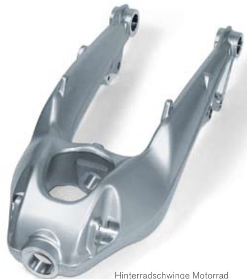
Hinterradschwinge Motorrad Silafont-20 dauerveredelt Niederdruck-Kokillenguss 570 × 240mm, Gewicht: 4,5kg
