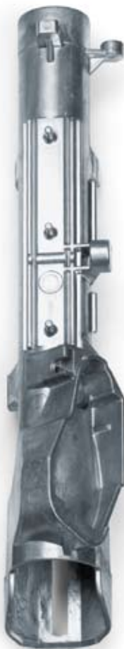
Mantelrohr mit Konsole Silafont-36 Druckguss 450 × 70 × 90 mm, Gewicht: 0,96 kg
