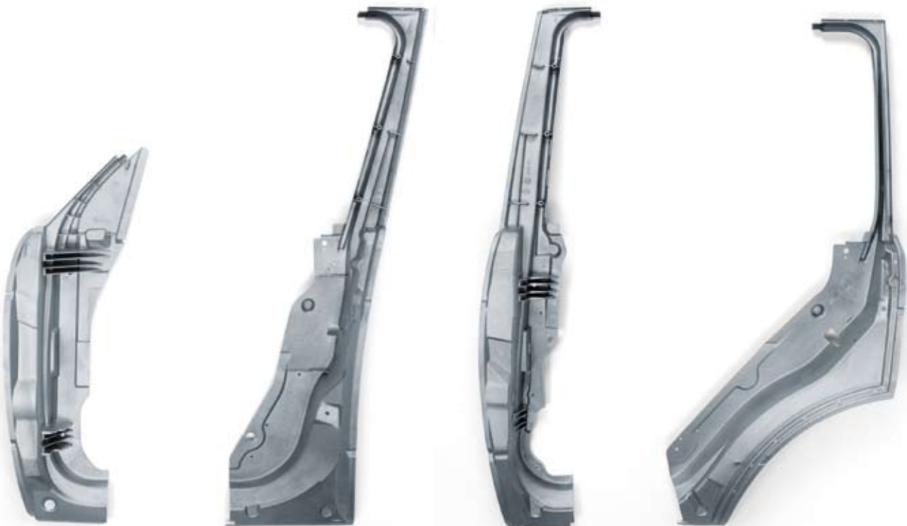
Türinnenteile für Geländefahrzeug Magsimal-59, Gusszustand Druckguss, schweißgeeignet, Wanddicke 1,8–2,0mm 1400 × 500mm bis 1000 × 240mm, Gewicht: 2,0–2,2kg
