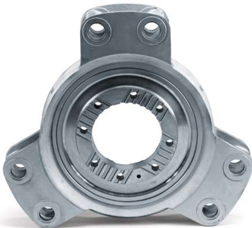
Gabelstern für Schienenfahrzeuggetriebe Alufont-48, warmausgehärtet Sandguss Ø 700 x 100mm, Gewicht: 38 kg
