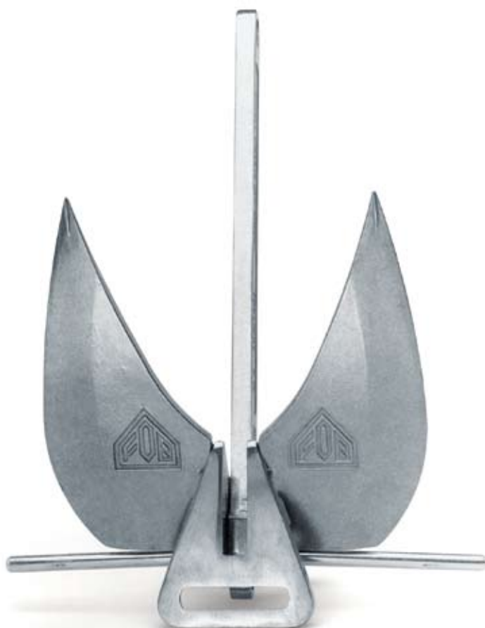
Stockanker für Hochsee-Segler Anticorodal-72, warmausgehärtet, teilausgehärtet Kokillenguss, Sandguss 660 × 460 × 180 mm, Gewicht: 5,4 kg
