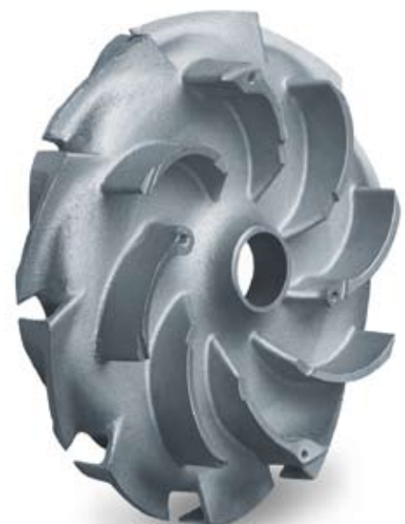
Leitrad für Kreiselpumpe Peraluman-56 Sandguss Ø 245 × 50 mm, Gewicht: 0,95 kg
