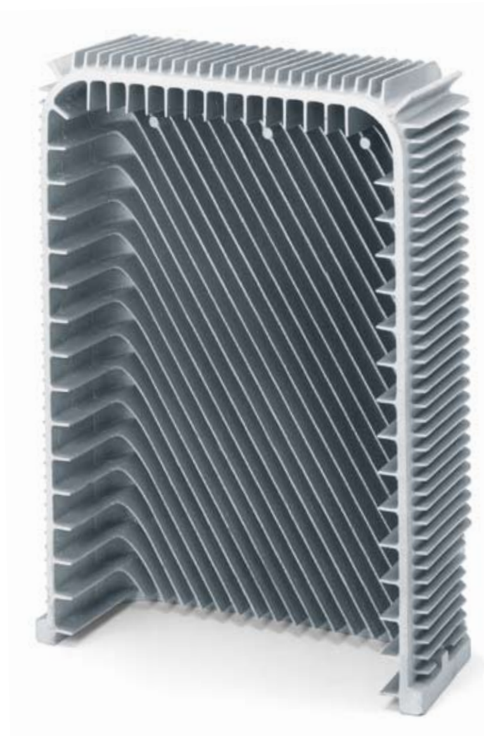
Kühlhalbschale für Röntgengeräte Peraluman-50 Sandguss 640 × 440 × 170mm, Gewicht: 19kg
