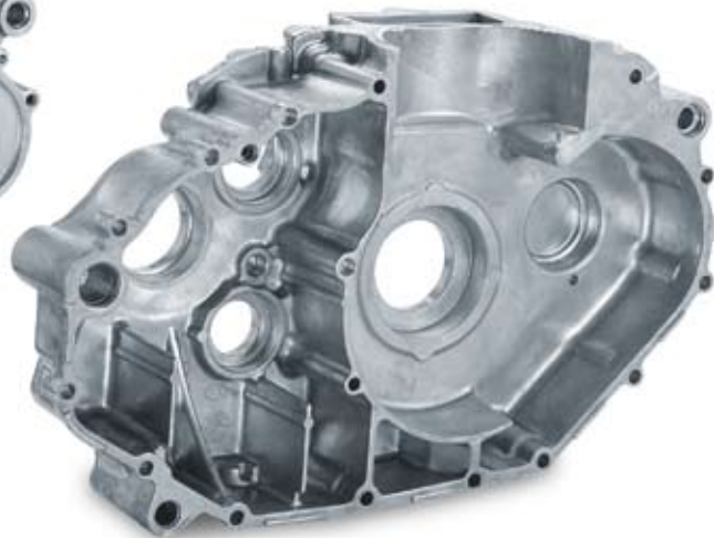
Getriebegehäuse für Motorrad Silafont-36, warmausgelagert Druckguss 400 × 270 × 80mm, Gewicht: 3,9kg 400 × 270 × 120mm, Gewicht: 3,8kg
