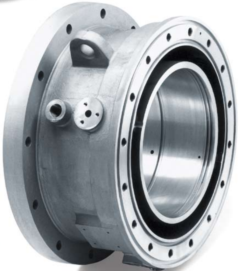
Zwischenflansch für SF 6 -Schaltanlage Silafont-30, warmausgehärtet Sandguss, druckdicht Ø 560 × 270mm, Gewicht: 64kg
