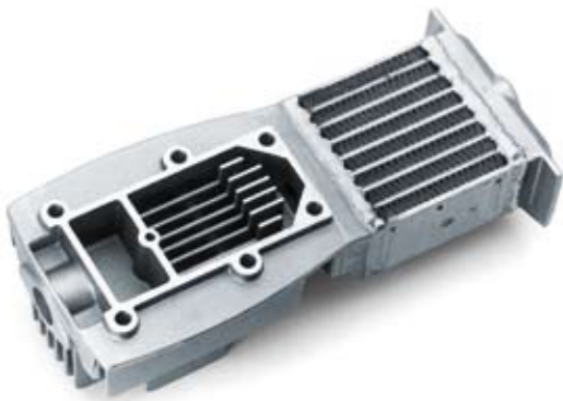
Zylinderkopf für Kompressor Silafont-30, Gusszustand Kokillenguss, verschweißt, druckdicht 390 × 160 × 110mm, Gewicht: 4,2kg
