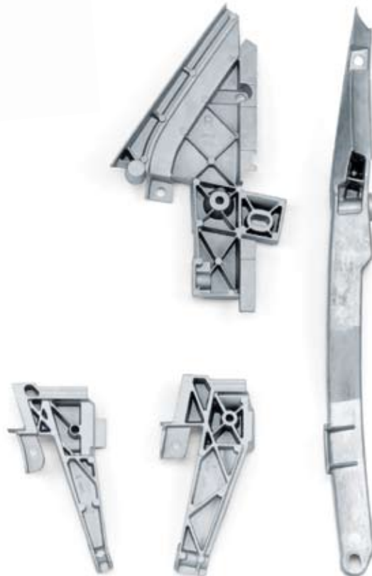
Knoten für Fensterrahmen Magsimal-59, Gusszustand Druckguss, schweißgeeignet Bis 510 mm lang, Gewicht: 0,20 – 0,35 kg
