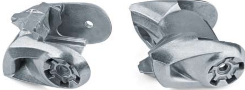
Skibindung Magsimal-59, Gusszustand Druckguss, poliert 77 × 69 × 53 mm, Gewicht: 150 g
