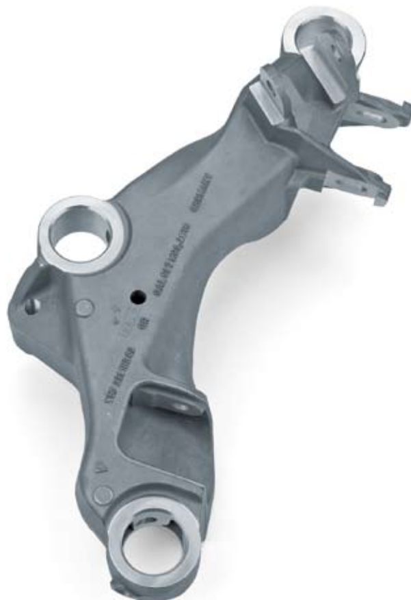
Längsträger für Radaufhängung Anticorodal-70, warmausgehärtet Sandguss mit einteiligem Kern 450 × 200 × 135mm, Gewicht: 2,5kg
