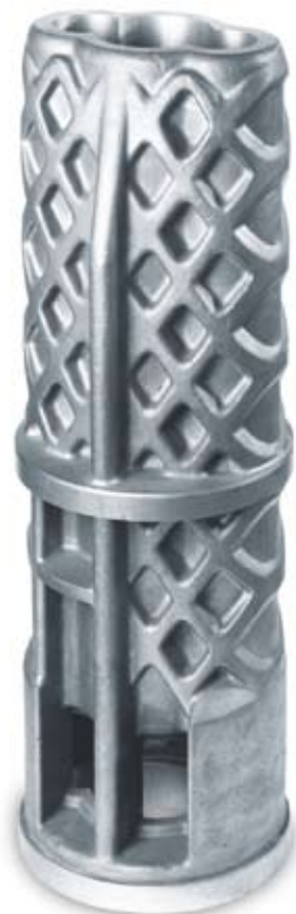
Gehäuse für Schraubenspindelpumpen Silafont-70, warmausgehärtet Sandguss Ø 200 × 700 mm, Gewicht: 12,0 kg
