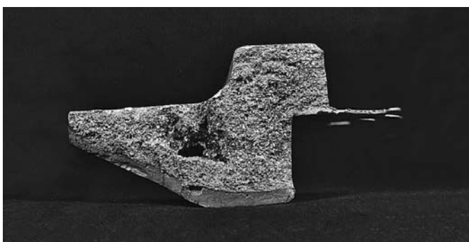
Abb. 2: Mittellinienlunker im lamellaren Gussgefüge
