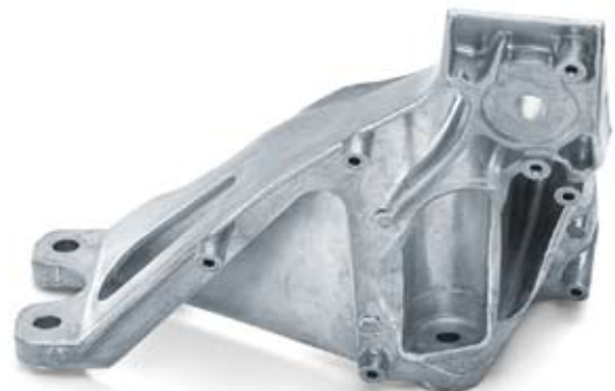
Motorträger für BMW-Magnesiummotor Silafont-36 Druckguss 270 × 170 × 210 mm, Gewicht: 1,5 kg
