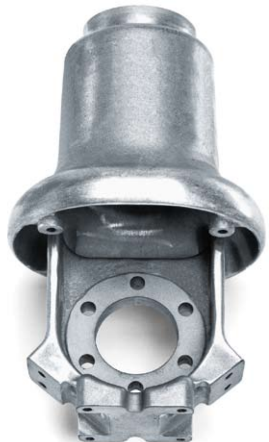
Elektrischer Leiter in Schaltgehäusen Anticorodal-71, überaltert Sandguss, oberflächengeschliffen 350 × 210 × 180 mm, Gewicht: 4,1 kg
