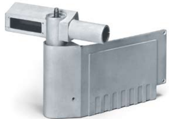
Eingabegehäuse für Selbststeueranlage an Hochseeyachten Peraluman-50 Sandguss, anodisch oxidiert 290 × 210 × 40mm, Gewicht: 0,4kg
