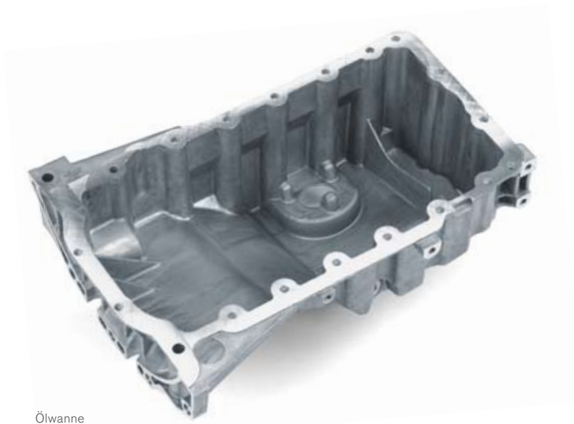
Ölwanne Magsimal-59, Gusszustand Druckguss, Wanddicke 2,2 mm 440 x 310 x 180 mm, Gewicht: 3,0 kg
